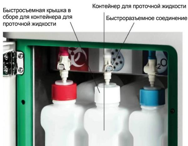
Рис. 4. Контейнер для проточной жидкости с быстроразъемной системой
