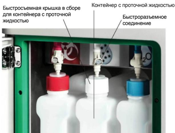
**Рис. 29. Жидкости системы струйной автоматки с отмеченными компонентами контейнера для проточной жидкости**
