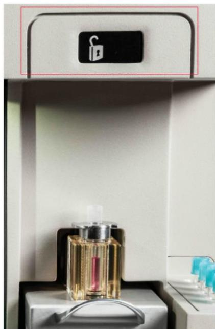
Рис. 7. Экран системы сенсорной блокировки
