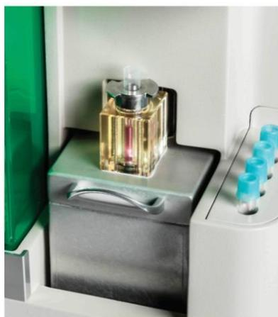
Рис. 5. Загрузочная платформа в положении промывки
